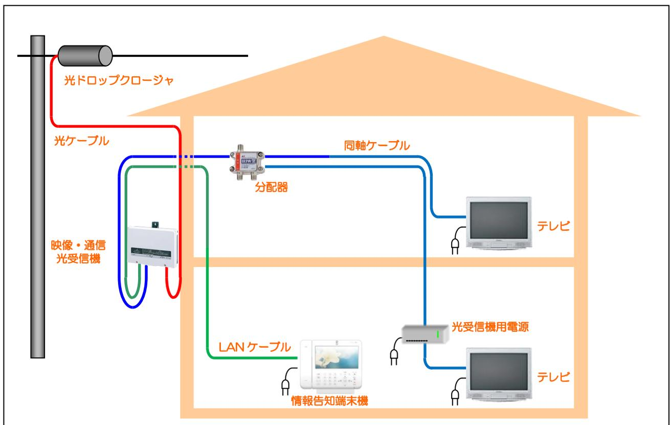
通信サービスおよび放送サービスに加入の場合の引込～宅内配線・設備の例
